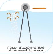
Biolac® requiert généralement 30 à 50 % de l'énergie consacrée aux fins de diffusion de l'oxygène. C'est pourquoi il est possible de réduire l'approvisionnement en air en période de faibles charges tout en préservant l'efficacité de l'alimentation de la biomasse et sans courir le risque de sédimentation des matières solides hors des eaux usées.
